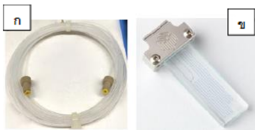
รูปที่ 2 แสดงลักษณะของส่วนทำปฏิกิริยา (ก) แบบท่อ และ (ข) แบบไมโครฟลูอิดิกส์ ที่มา: Britton J, Jamison TF (2017)
