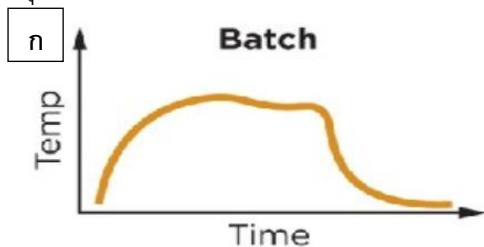
รูปที่ 12 แสดงการเปลี่ยนแปลงอุณหภูมิของการสังเคราะห์ด้วย (ก) ถังผสมและ (ข) เคมีการไหล ที่มา: Syrris (2022)
